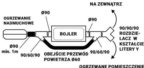
**BARDZO ZALECANY PRZY MONTAŻU Z OGRZEWANIEM 4KW,**
