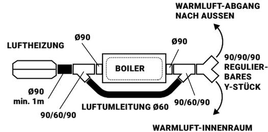
STRENG EMPFOHLEN FÜR INSTALLATIONEN MIT 4KW HEIZUNG, FÜR 2KW EBENSO GEEIGNET.
