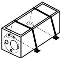
Bojler montujemy za pomocą dwóch plastikowych kątowników 2szt, opaski zaciskowej 2szt. oraz uchwytyw mocujących z otworem Ø5mm 4szt.
